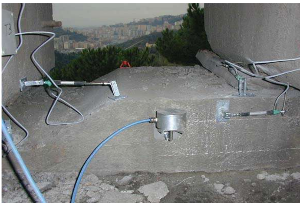
Foto 26 – 27: vista d'insieme di un'area in frana in cui ricade un importante viadotto e parte della strumentazione di monitoraggio installata per il controllo dell'opera
