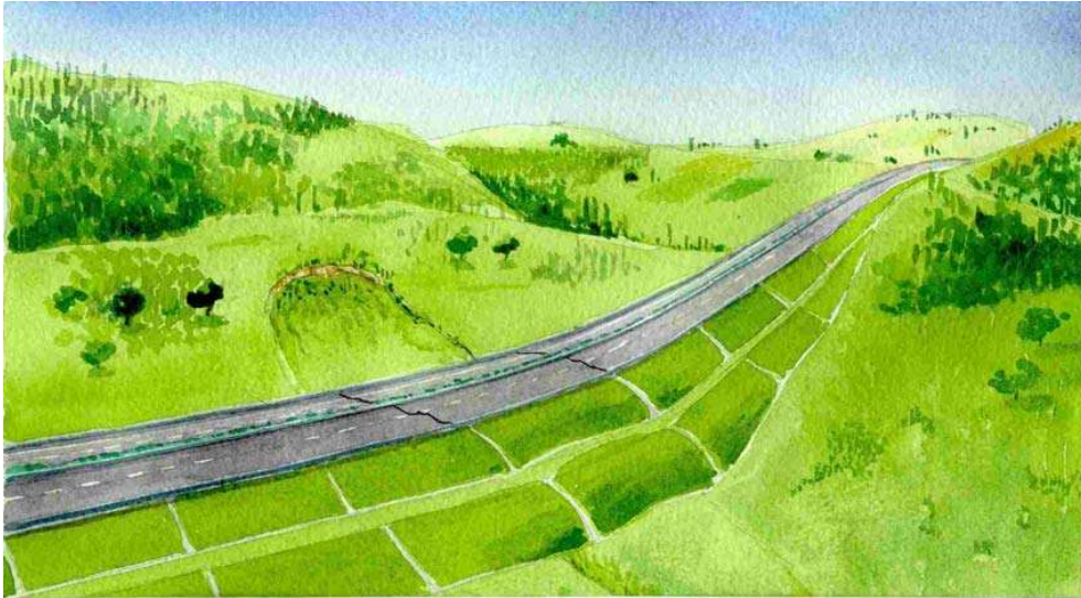
Fig. 3b – Instabilità del corpo del rilevato coinvolgente il piano di posa (frana rotazionale). In questo secondo caso illustrato, le lesioni si spingono alla carreggiata di monte ed oltre, poiché la parte sommitale del movimento franoso è ubicata sulla pendice a monte. Le lesioni sulla sede viabile sono decisamente trasversali all’asse dell’autostrada e quasi parallele fra loro.
