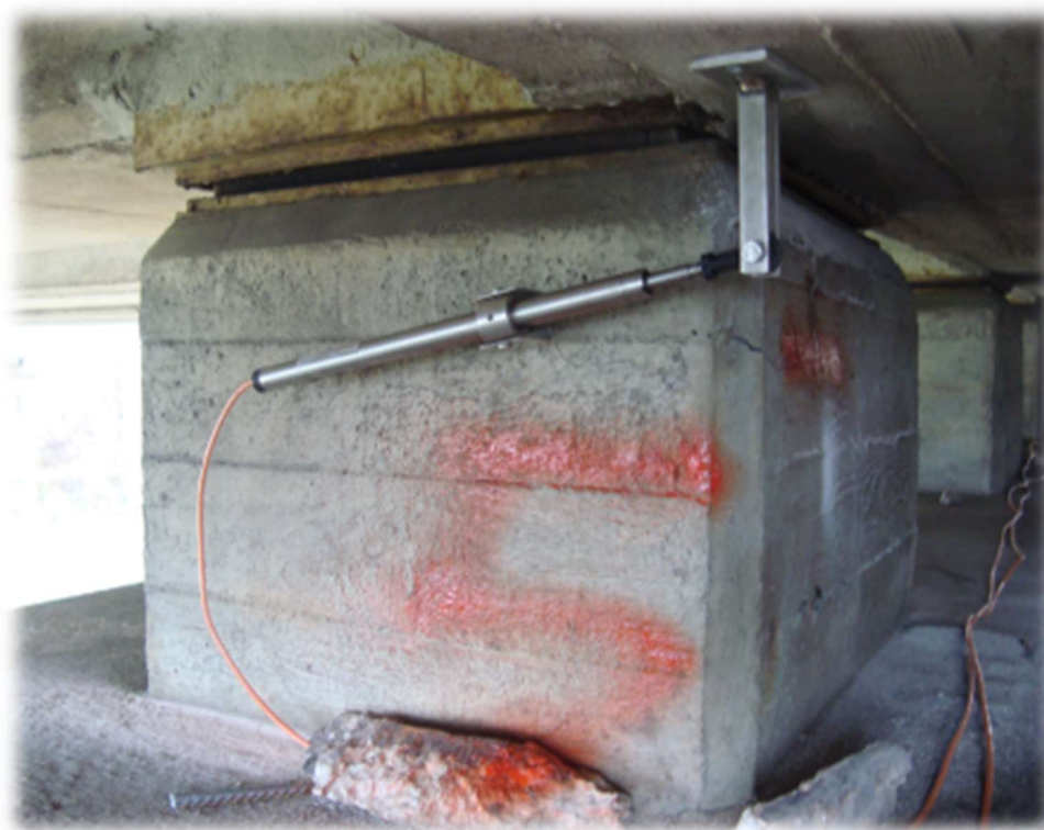
Foto 31: FESSURIMETRI (ad acquisizione continua e trasmissione dati real time)
